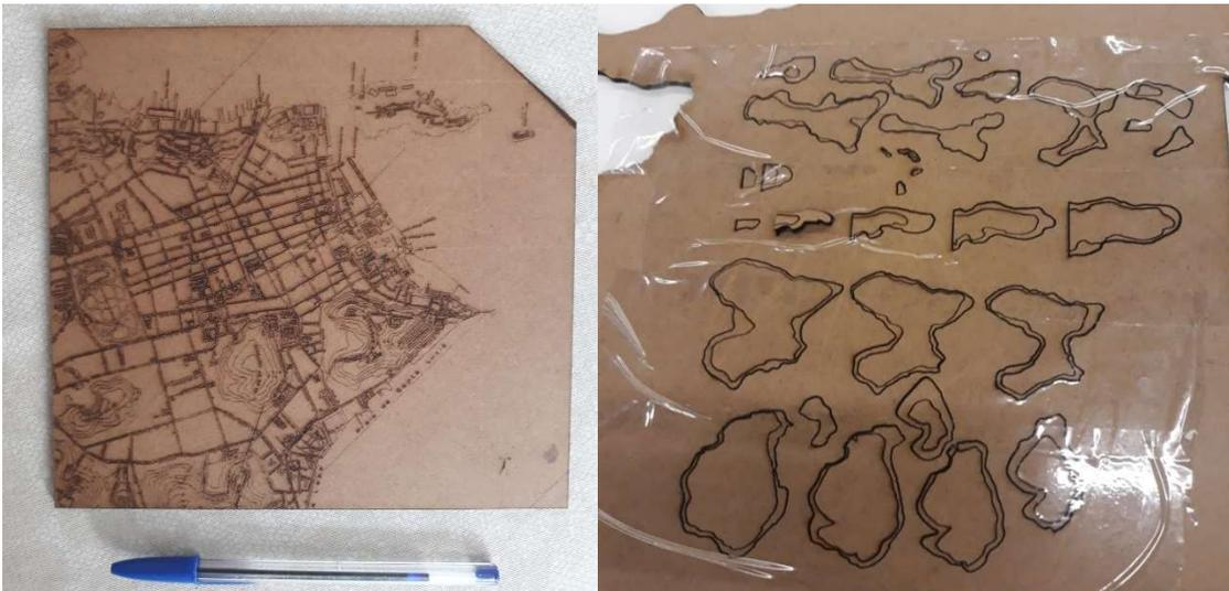
Figura 3. Marcação da Carta na base da maquete e recorte de curvas de nível.
