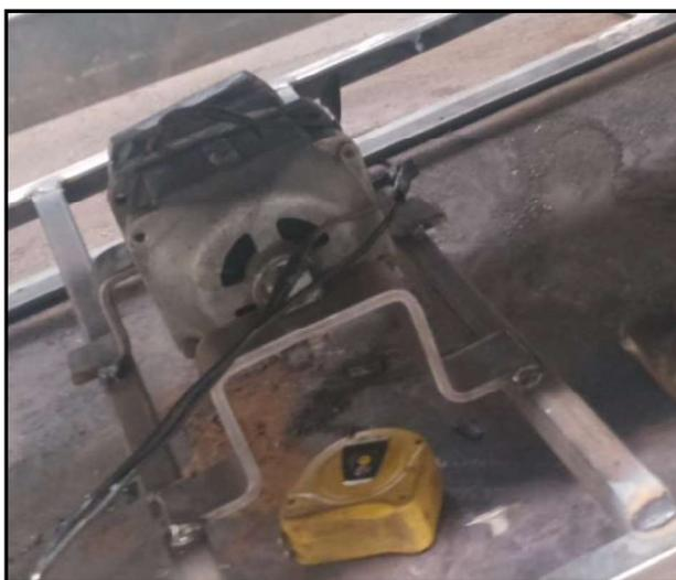
**Figura 6:** Motor e Chapas de Contrapeso. Fonte: (Autores)
