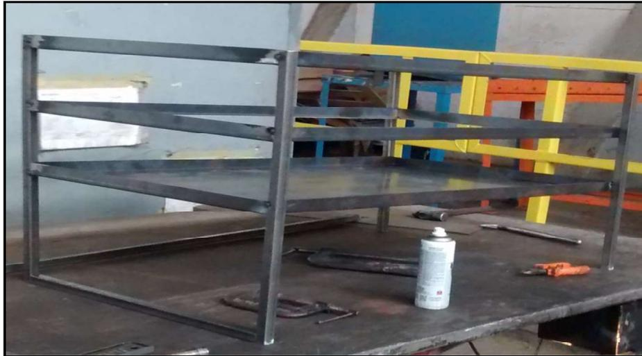
**Figura 3:** Estrutura Soldada. Fonte: (Autores)
