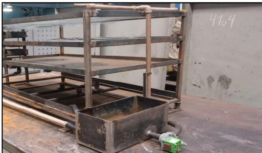
**Figura 5:** Bomba, Reservatório e Tubulações. Fonte: (Autores)
