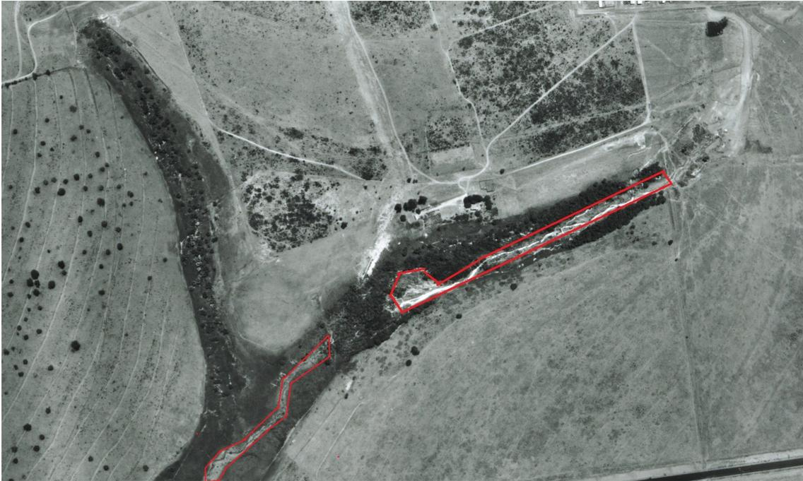
Figura 3: Expansão do processo erosivo na cabeceira do córrego.
