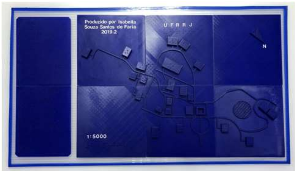
Figura 6. Mapa tátil da UFRRJ, impresso e fixado sobre o policarbonato.
