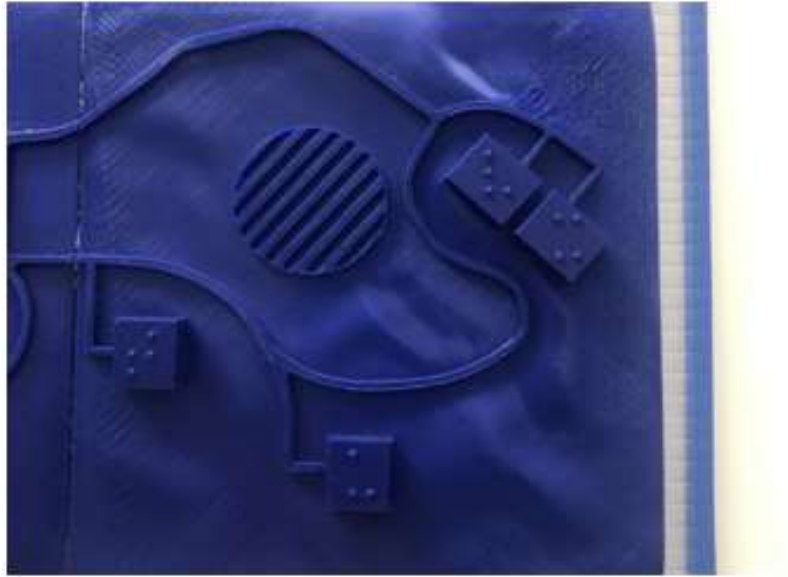
Figura 8. Deformação ocorrida em parte do mapa tátil devido à exposição a alta temperatura.
