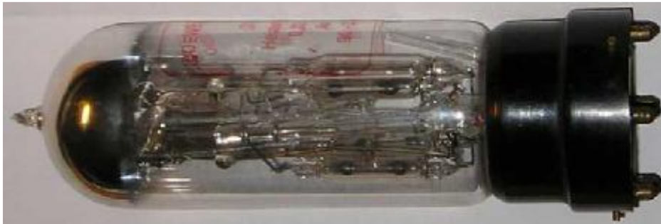
Figura 2. 3NF, o primeiro circuito integrado. Fonte: Radio Museum
