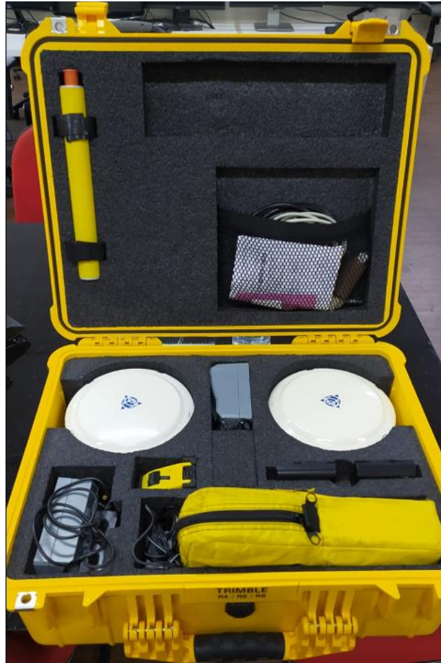
Figura 2. Foto do GNSS Trimble R6 para realização dos levantamentos. (Fonte: Douglas Martins)
