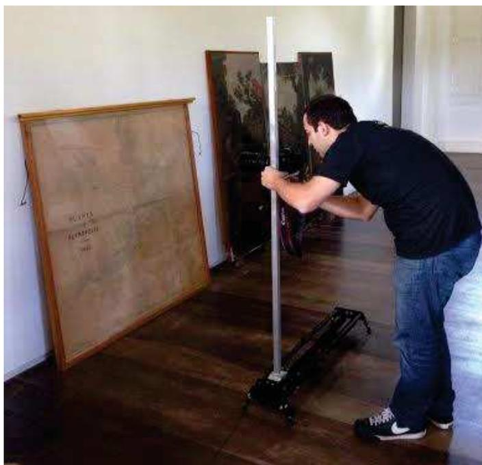
Figura 1. Sistema utilizado com o trilho, baliza e câmera digital de alta resolução para levantamento fotográfico da planta Koeler.
